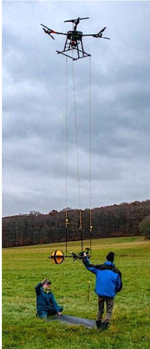
Testflug mit einem neuen Prototyp eines elektromagnetischen Empfängers. Dieser misst ein Feld, das von einem nahen Sender ausgestrahlt und durch den Untergrund moduliert wird. Mit der Methode wird es möglich sein, geologische Strukturen, Rohstoffe, Wasser bis in Tiefen von mehreren 10er-Metern zu erkennen. Quelle: <https://www.geologie.ac.at/>
